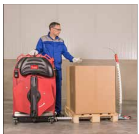
fører omsnøringsbåndet under pallen...
