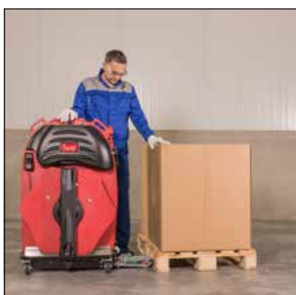
Kør ErgoPack'en hen foran pal-len, kædelansen...
