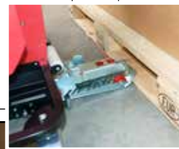
Kør ErgoPack'en hen foran pal-len, kædelansen...
