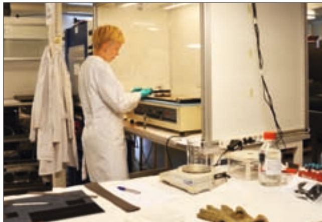
Membranerne fremstilles ved håndkraft. Det er vigtigt, at PBI-laget er meget jævnt. Membranen har en tykkelse på 40 my ±2 my. Der kan i øjeblikket fremstilles otte stykker om dagen.
